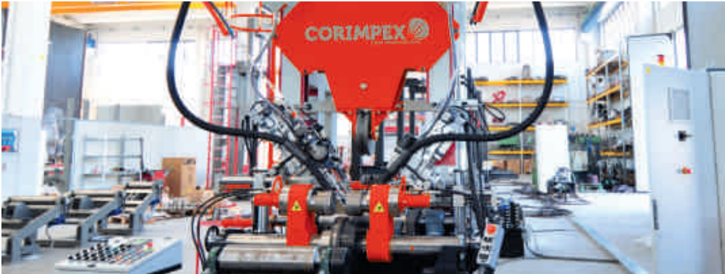
Automatic centering & flange post deforming device - Sistema automatico di centraggio e raddrizzatura ali
