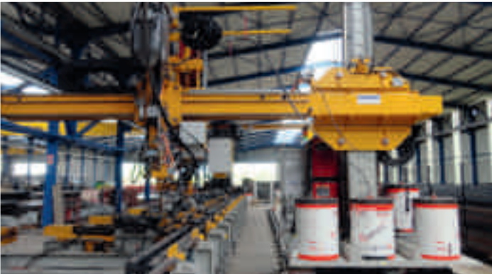
Column and boom manipulator with Twin welding heads Manipolatore a doppia testa di saldatura
